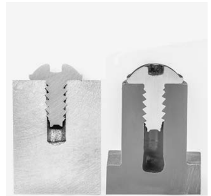
Hohe Flankenüberdeckung bei Verschraubungen in Leichtmetallguss-Legierungen und Kunststoffe realisierbar
