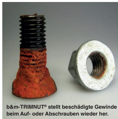
Nicht mehr funktionsfähige Gewinde verursachen eine aufwendige Nachbearbeitung oder den Austausch ganzer Baugruppen.
