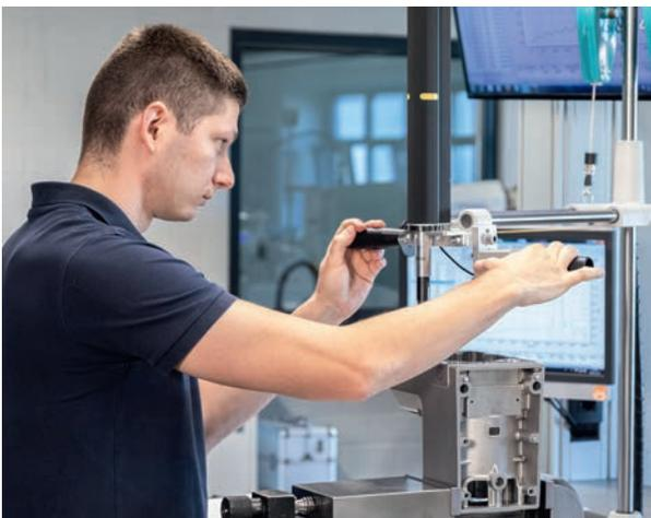
Laborexpertise: Speziell ausgebildete Anwendungstechniker legen die Einschraubparameter für die Bauteile unserer Kunden aus.
